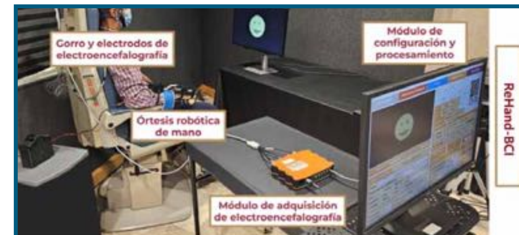
Interfaz Cerebro-Computadora para Neurorrehabilitación (ReHand-BCI) desarrollado en la SIT. Se muestran los componentes del dispositivo y la configuración usada durante una sesión de terapia para extremidad superior
