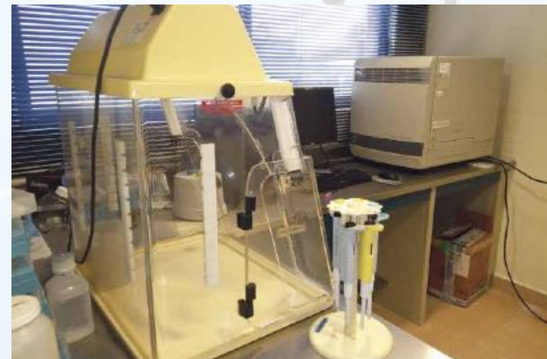
Figura 2. Equipo de PCR en tiempo real Fast-Real Time 7900 de Applied Biosystems, para el análisis de los polimorfismos genéticos de diferentes genes.
